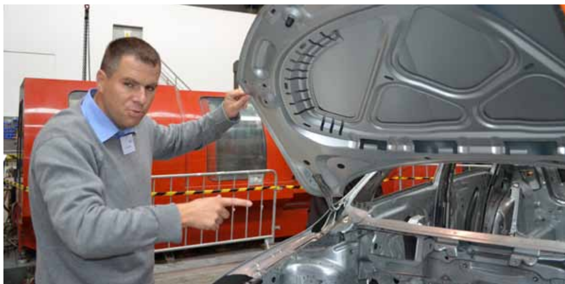
Radek Bulíček vysvětluje konstrukci kapoty, která má při nárazu omezit poranění chodců. FOTO | TOMÁŠ HEJTMÁNEK
